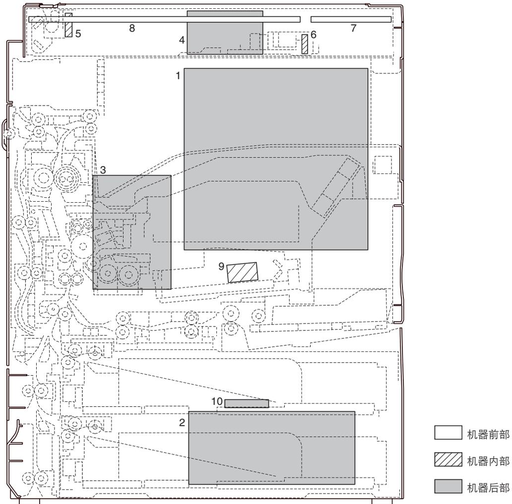
图 2-2-1 印刷电路板
