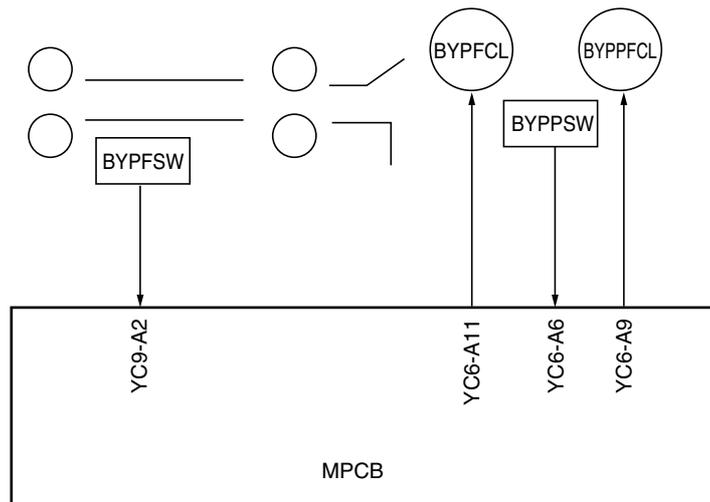
图 2-1-4 供纸部框图（手送供纸台）
