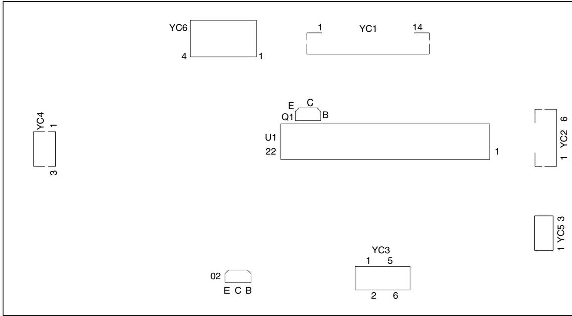
图 2-3-9 扫描驱动电机电路板丝印图
