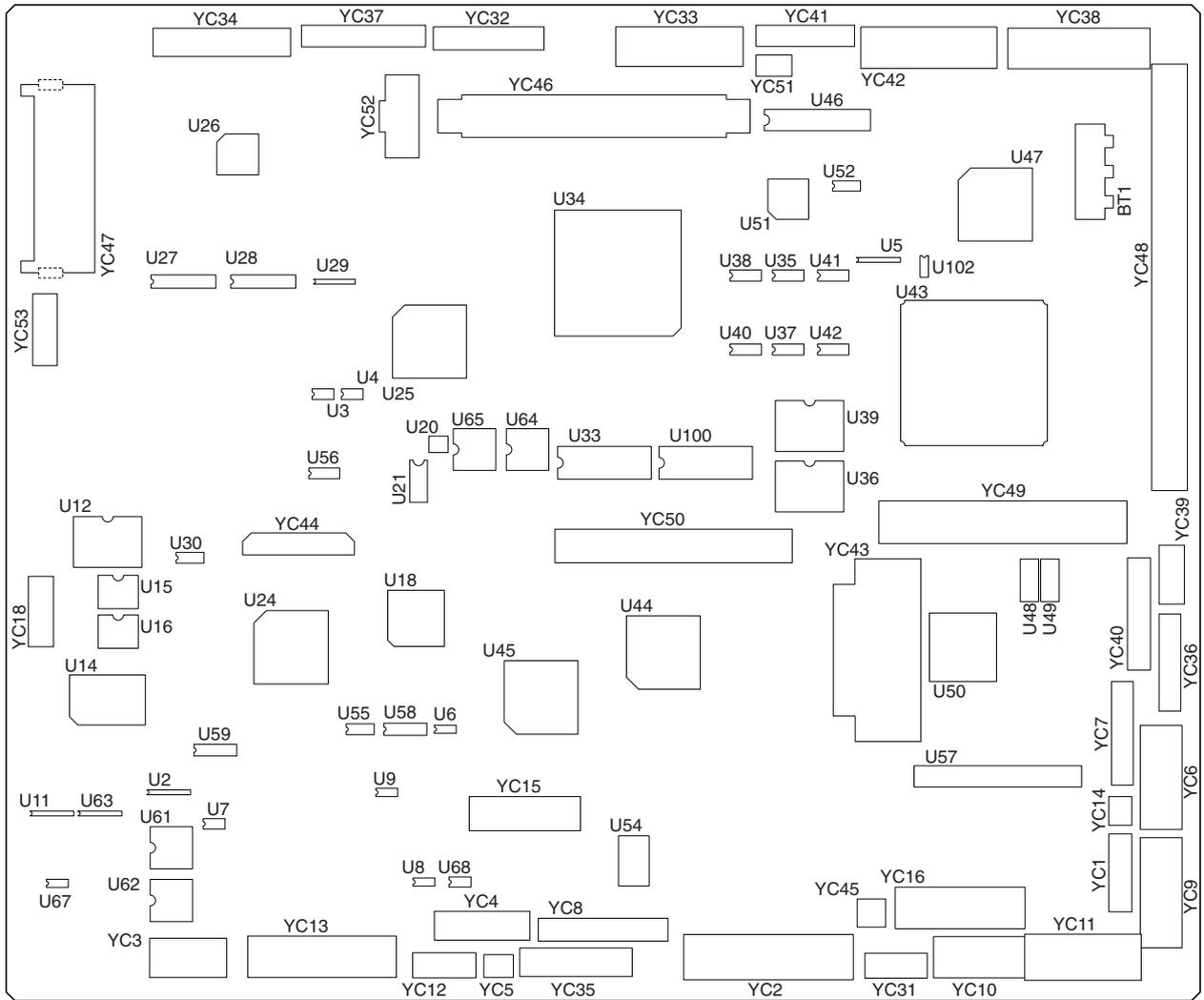
图 2-3-4 主控板丝印图
