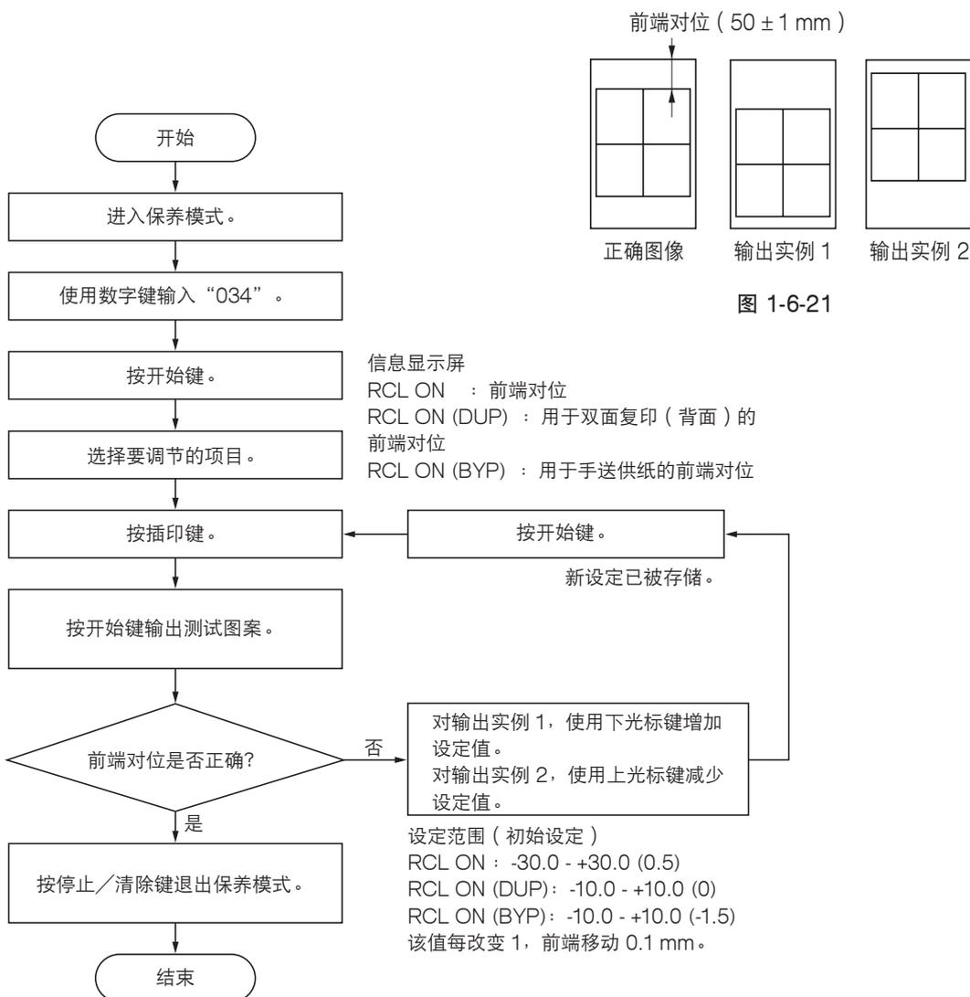
( 3-2 ) 调节存储图像打印的前端对位
