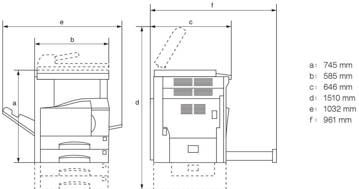
图 1-2-1 安装尺寸
